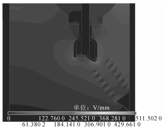
图 12 分压电容绝缘子处场强分布图
